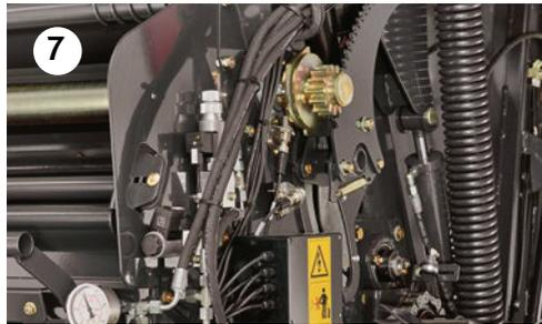
7 Proportionalventil für Dichtregelung von der Fahrerkabine aus
