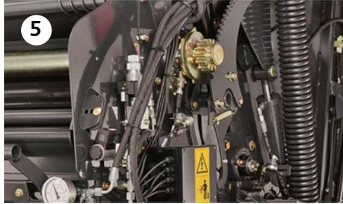
Proportionalventil für Dichtregelung von der Fahrkabine aus
